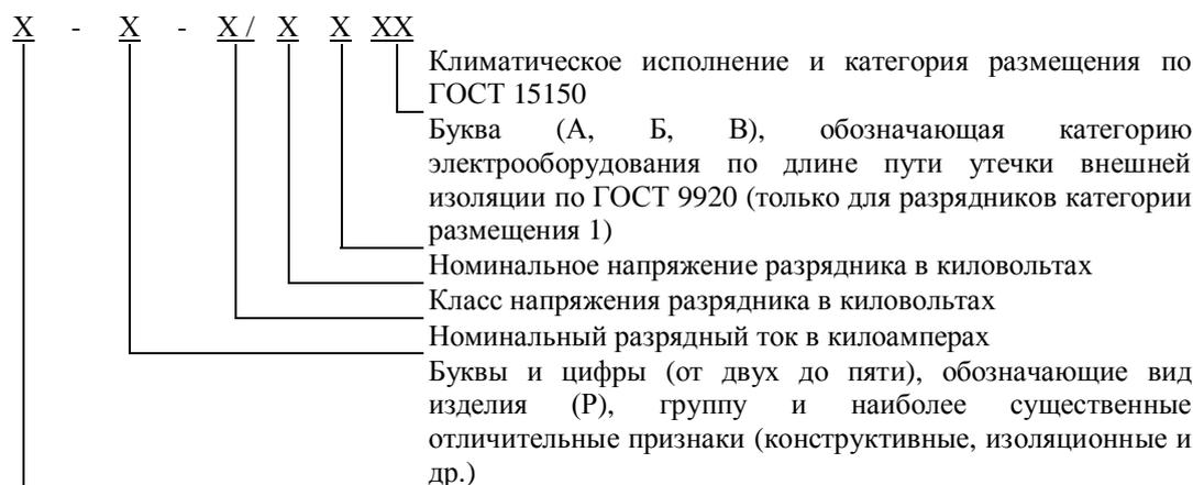
Пример условного обозначения разрядника вентильного серийного группы III на номинальный разрядный ток 5 кА, класс напряжения 110 кВ, номинальное напряжение разрядника 102 кВ, категории по длине пути утечки на 20 % выше А, климатического
